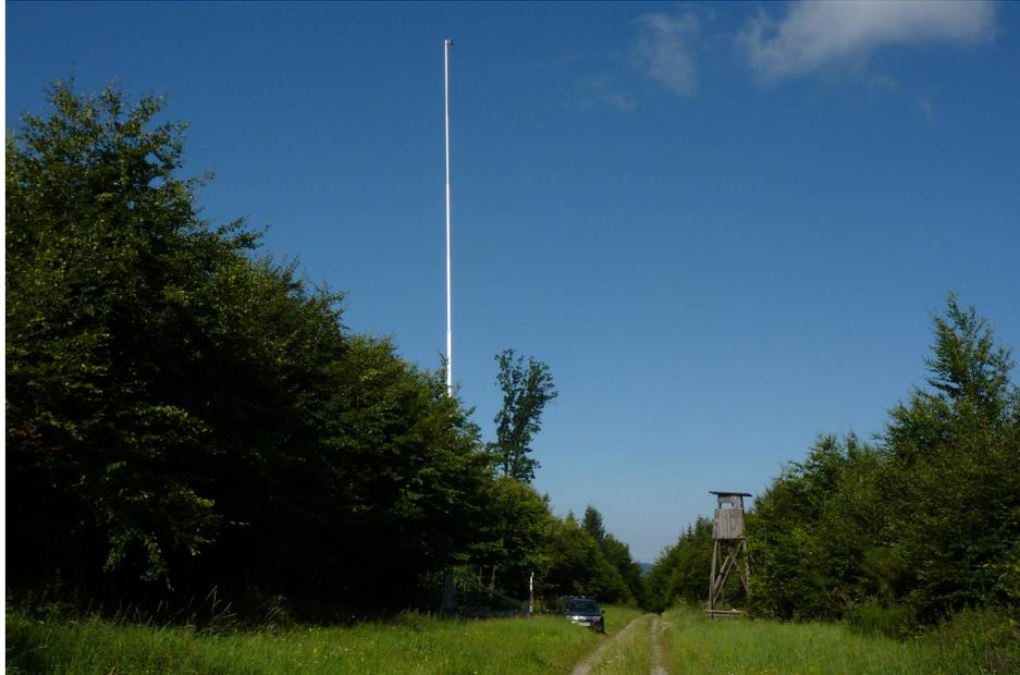
Abb. 4: Teleskopmast am 10.08.2012 an der Position Hebert 2. Der Batcorder an der Spitze des Masts ist als schwarzer Punkt zu erkennen. Die Höhe betrug 36 m.
