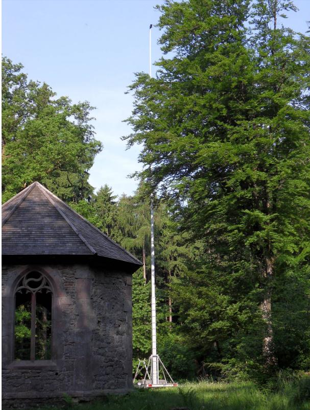
Abb. 2: Teleskopmast am 23.05.2012 am Heiligkreuzkirchlein. Der Batcorder an der Spitze des Masts ist als schwarzer Punkt zu erkennen. Die Höhe betrug 36 m.
